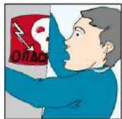
Напряжение в проводах железной дороги – почти 30000 вольт. Приближаться к ним на расстояние ближе двух метров опасно!
